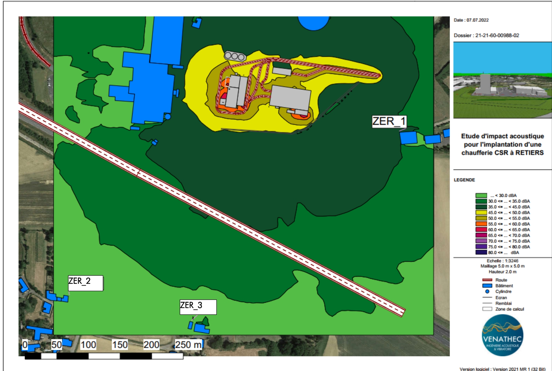
Carte de bruit – Etat futur avec préconisations – Période nocturne (hauteur de 2m)
