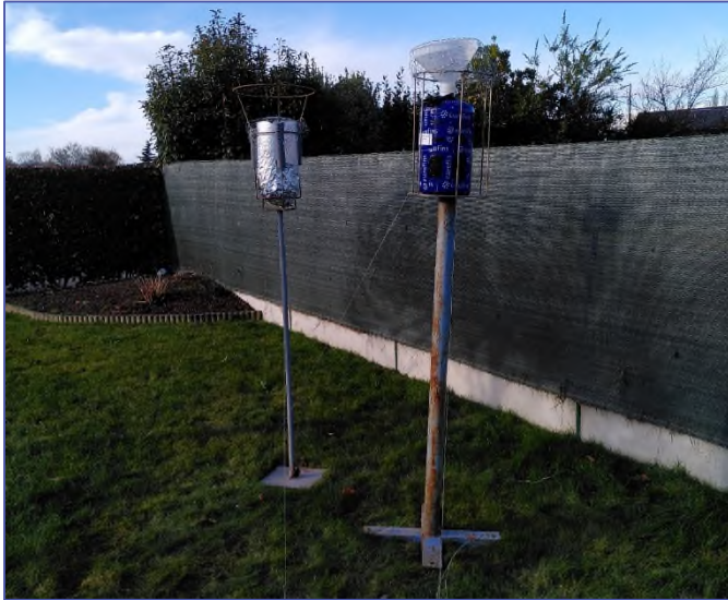
Figure 7-2 Photographie d'un prélèvement par Jauge Owen (P3)
